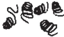
Falls die Späne dünn oder pulverförmig sind steigern Sie den Schnittdruck.
